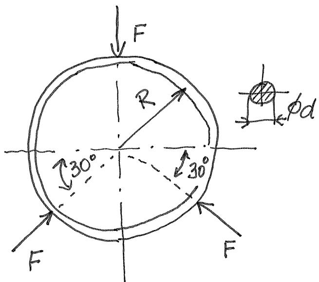
Tenka' obrouč je zatížena' dvěma silami. Určete místo a velikost největšího momentu a můžete náležet  $\rho_d$  průřezu. Zároveň průběh  $M(\varphi)$ .
